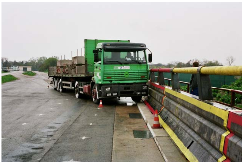
Bild 11: Fahrzeug am erwarteten Anprallpunkt
