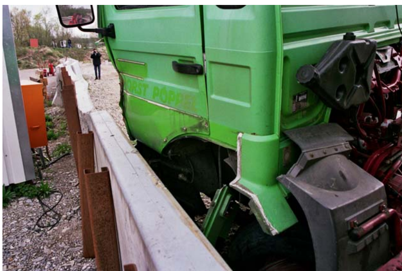
Bild 53: Fahrzeugschäden (linke Fahrzeugseite)
