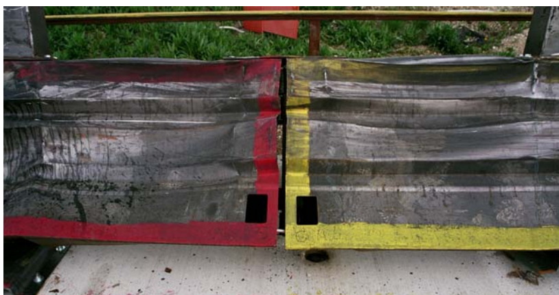
Bild 48: Längsver schiebung einer Elementeverbindung
