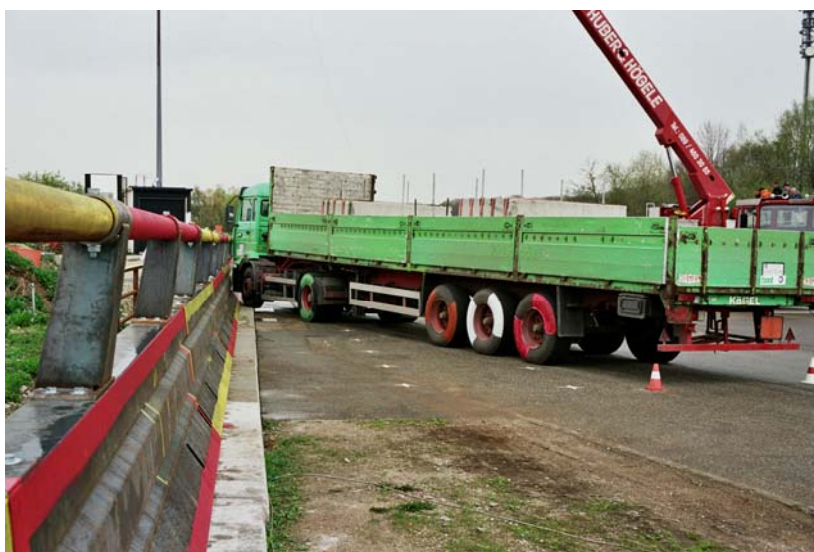
Bild 12: Fahrzeug am erwarteten Anprallpunkt
