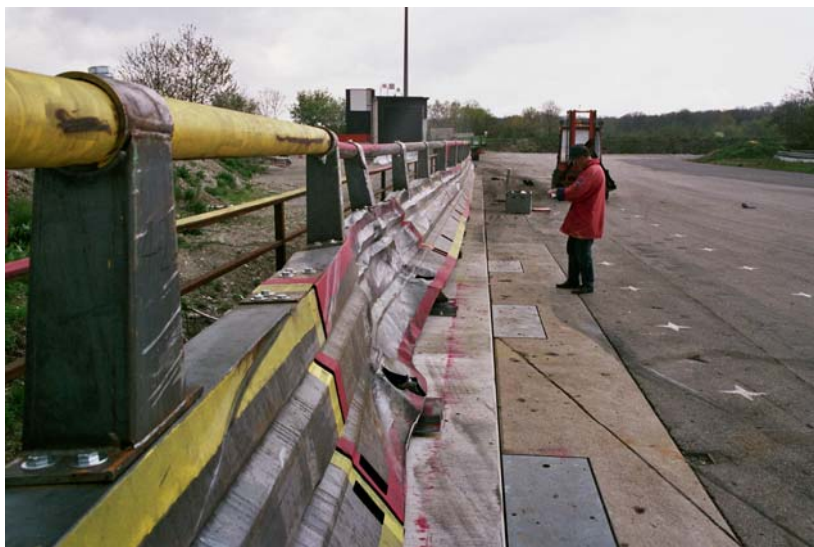
Bild 36: Durchbiegung der Schutzeinrichtung nach der Prüfung
