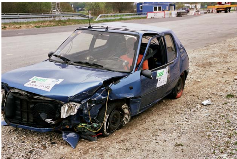
Bild 34: Fahrzeugschäden (linke Fahrzeugseite + Front)
