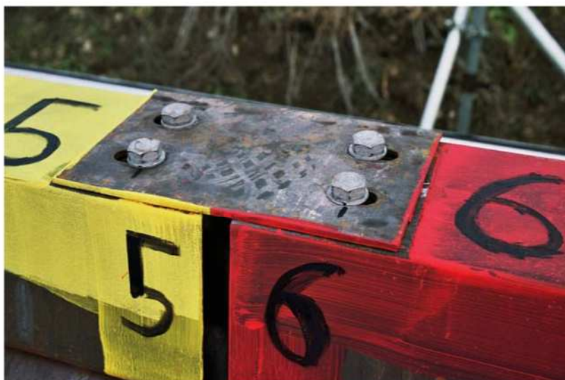
Bild 36: Längsverschiebung an Kopfverbindung Stoß 5/6
