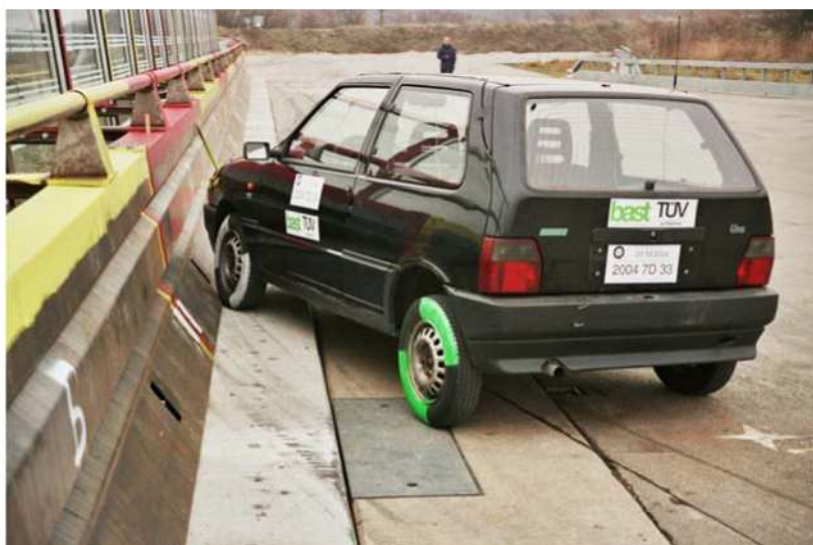
Bild 12: Fahrzeug am Anprallpunkt
