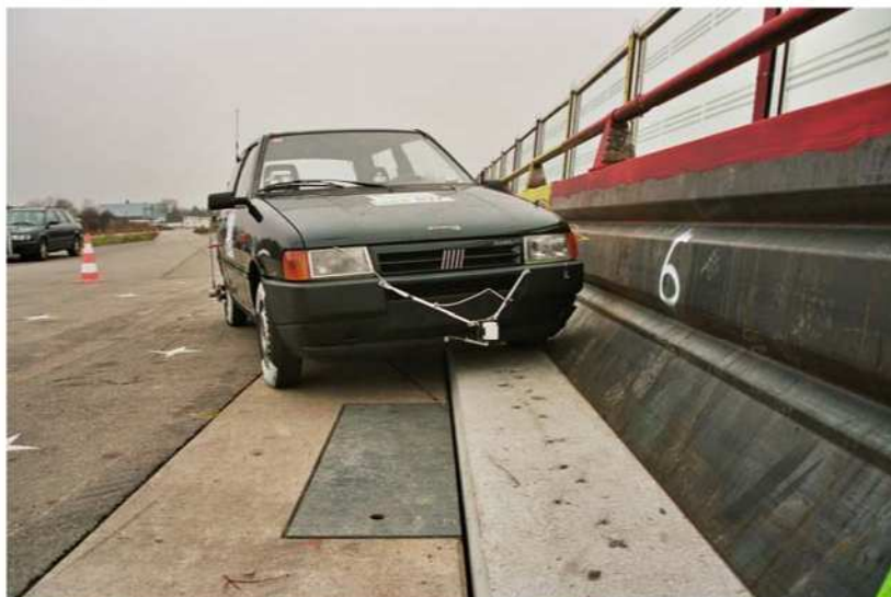
Bild 11: Fahrzeug am Anprallpunkt
